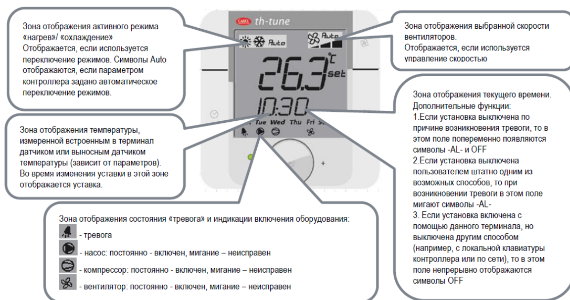
Рис.28. - Внешний вид и описание дисплея терминала th-Tune.
