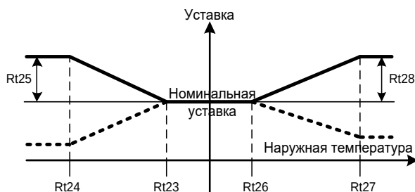
Рис.19.- Параметры компенсации уставки.
