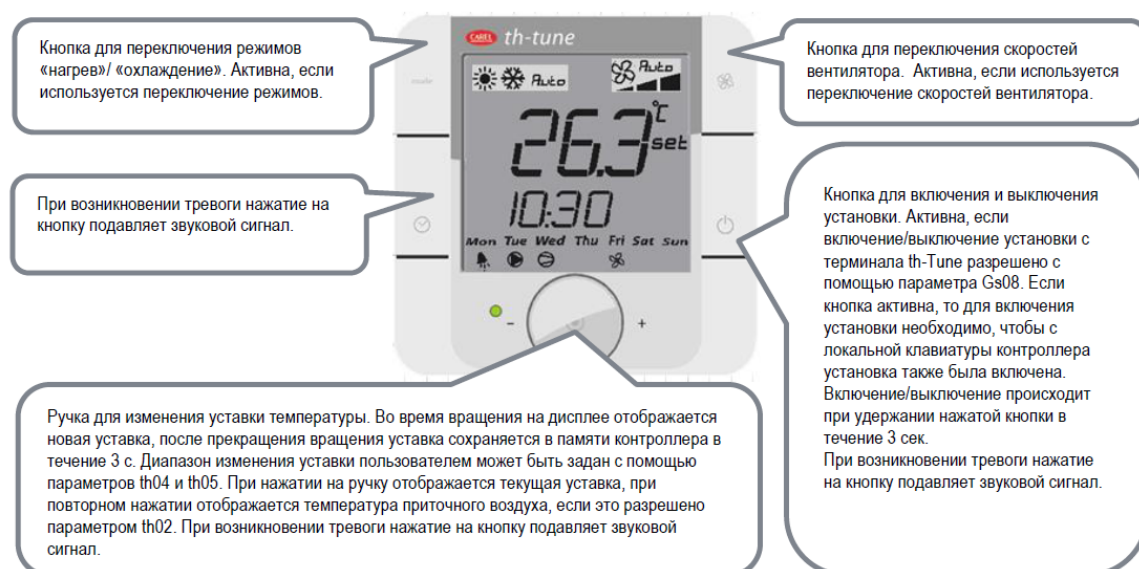
Рис.29. - Описание кнопок дисплея терминала th-Tune.
