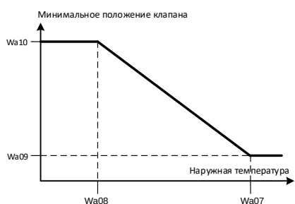
Рис. 13. – Зависимость положения клапана от наружной температуры
